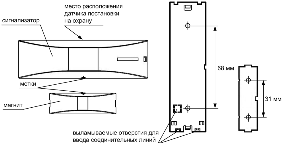
Рис.9 Схема установки, присоединительные размеры
